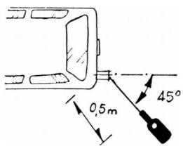
e) a saída de escape tem de ser feita na traseira, longitudinalmente ao eixo do veículo, e não pode ultrapassar os contornos da carroçaria. Nenhuma alteração ao pára-choque é autorizada, com excepção da montagem de uma protecção térmica.
