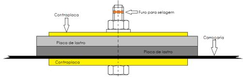
A superfície de contacto mínima entre a carroçaria/chassis é de 40cm² por cada ponto de fixação. iii. É proibido qualquer sistema de lastro móvel
