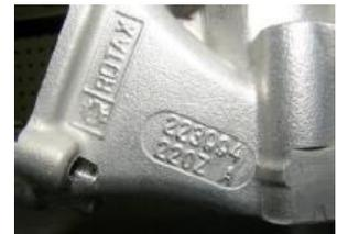
b) O cilindro do motor 125 Max Evo possui uma janela de escape principal e válvula de escape eletrónica. Tem a referência Rotax 613372 e está marcado (fundido ou maquinado) com o número 223993.
