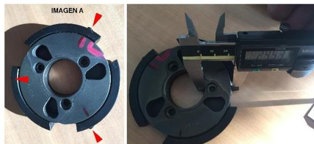
6.7.7.3. **Diâmetro exterior da campânula.** O diâmetro exterior da campânula deve ser medido conforme indica a imagem. A medição deve ser feita pelas costas da campânula e não pela parte da abertura da mesma (conforme imagem). O diâmetro mínimo é de **89,50 mm**.
