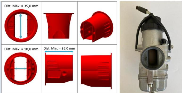
5.3.3. O uso do restritor de admissão (referência Rotax 267536) é obrigatório e deve ser colocado na posição correta, com a seta orientada para cima (exemplificado na seguinte figura). Não é permitido qualquer tipo de modificação. A existência de nervuras na superfície de admissão é para ajudar a garantir que as dimensões não foram modificadas.
