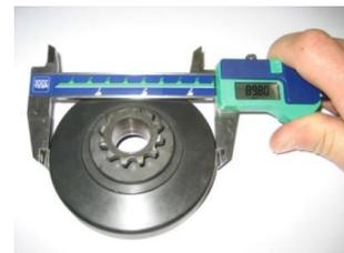
6.7.7.4. **Diâmetro interior da campânula.** A medição deve ser feita no meio (na área de contacto da campânula). O valor máximo do diâmetro interior é de **84,90 mm**.
