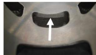
6.3.9. A parte superior da janela de escape pode apresentar superfícies apenas de fundição ou algumas zonas maquinadas de fábrica (CNC) ou sinais de maquinação (CNC) em combinação com sinais de acabamento manual. A janela de escape pode evidenciar algum acabamento manual feito pelo fabricante para eliminar defeitos menores de fundição e para eliminar restos de NIKASIL no final das zonas de banho de NIKASIL.
